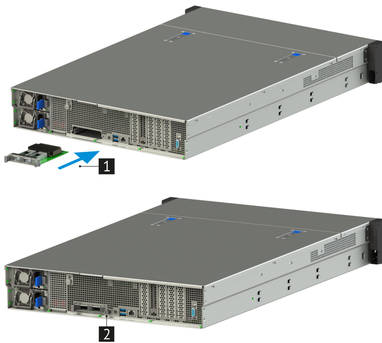
Рис. 59. Установка карты OCP 3.0 PCIe x16
