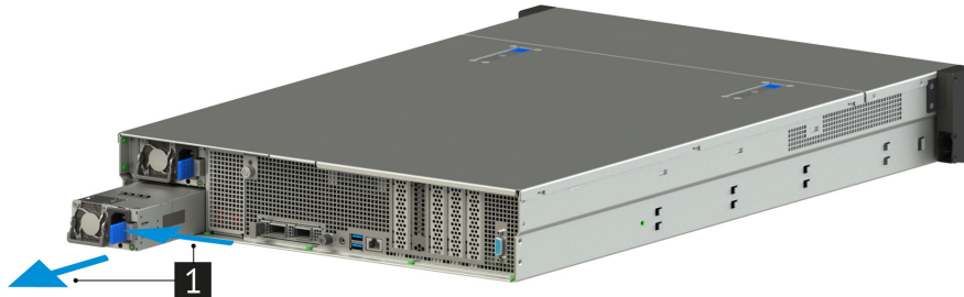
Рис. 63. Извлечение блока питания сервера
