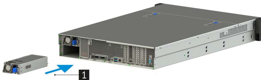
Рис. 62. Установка блока питания в сервер
