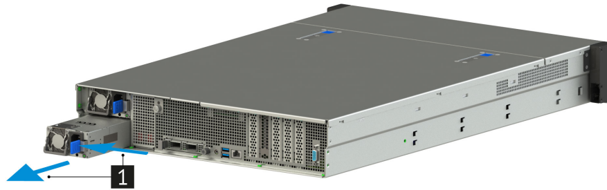
Рис. 61. Извлечение блока питания из сервера
