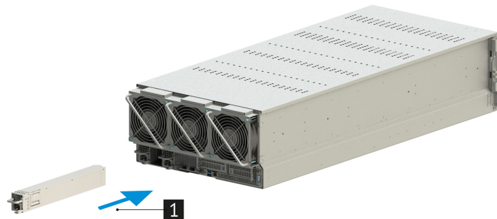
Рис. 61. Установка блока питания сервера
