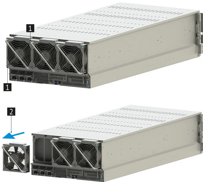
Рис. 31. Извлечение наружного вентилятора сервера
