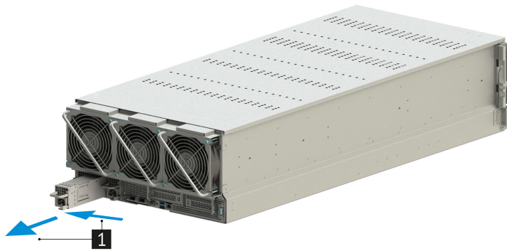
Рис. 58. Извлечение блока питания из сервера
