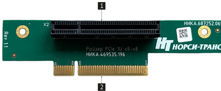
Рис. 12. Райзер PCIe 1U x8-x8 (НИКА.469535.196)
