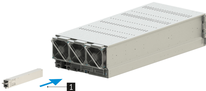
Рис. 59. Установка блока питания в сервер
