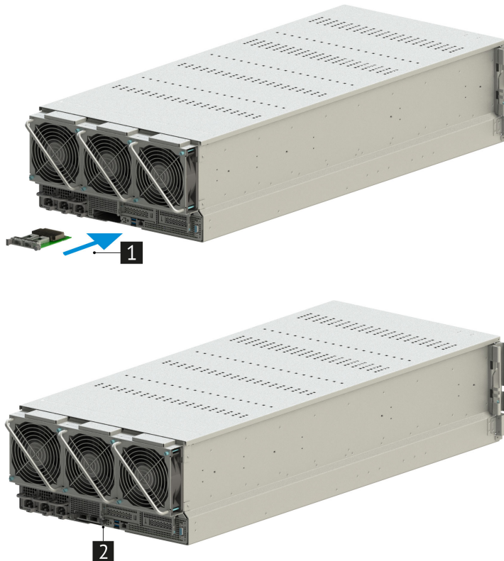
Рис. 54. Установка карты OCP 3.0 PCIe x16
