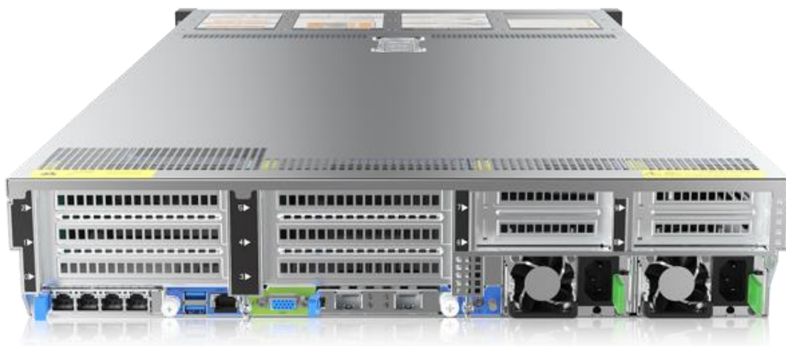
Рисунок 1. Серверная платформа QSRV-281200 (Вид сзади)
